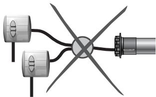
Ne pas brancher 2 inverseurs sur un moteur
