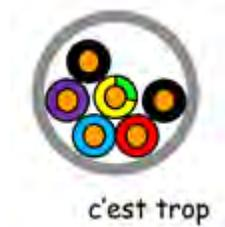
Les constructeurs proposent des documents pour déterminer rapidement la section des conduits
